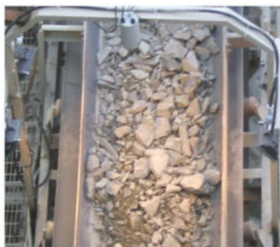
Figura 1.18 Proceso de tamizado a nivel industrial.
