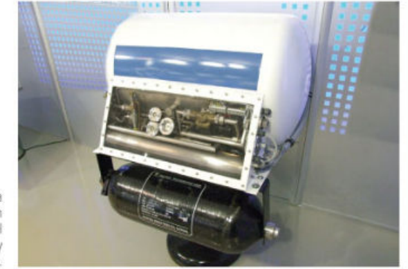
Figura 2.30 Tanque para automóvil que utiliza Hidrógeno como combustible. La obtención de H_2 se lleva a cabo mediante la hidrólisis del agua, es decir, la separación de Hidrógeno y Oxígeno requiere energía.
